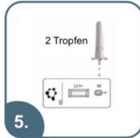
5. **Eingabe** von 2 Tropfen der Probe in Probenvertiefung der **Testkarte**.
